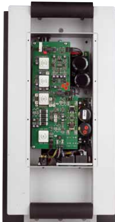
Vollaktiv: Kräftige Class-A/B-Endstufen treiben die Chassis an. Klanglich sind diese Amps erste Wahl
